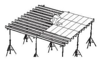
Las placas contrachapadas se instalan sobre las vigas secundarias y fijadas a éstas. La estructura de encofrado rígida debe ser arriostrada contra el edificio.
