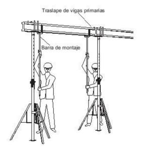
A continuación, las vigas H 20 son introducidas en las cabezas de puntal. La barra de montaje facilita enormemente este trabajo.
