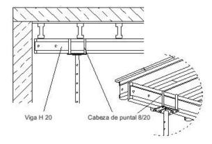
El desencofrado comienza con el descenso del puntal. En todos los puntales de acero tubular de, el pasador de descenso rápido libera de tensiones a la tuerca del puntal. Un simple martillazo normalmente basta para lograr un descenso del encofrado.
