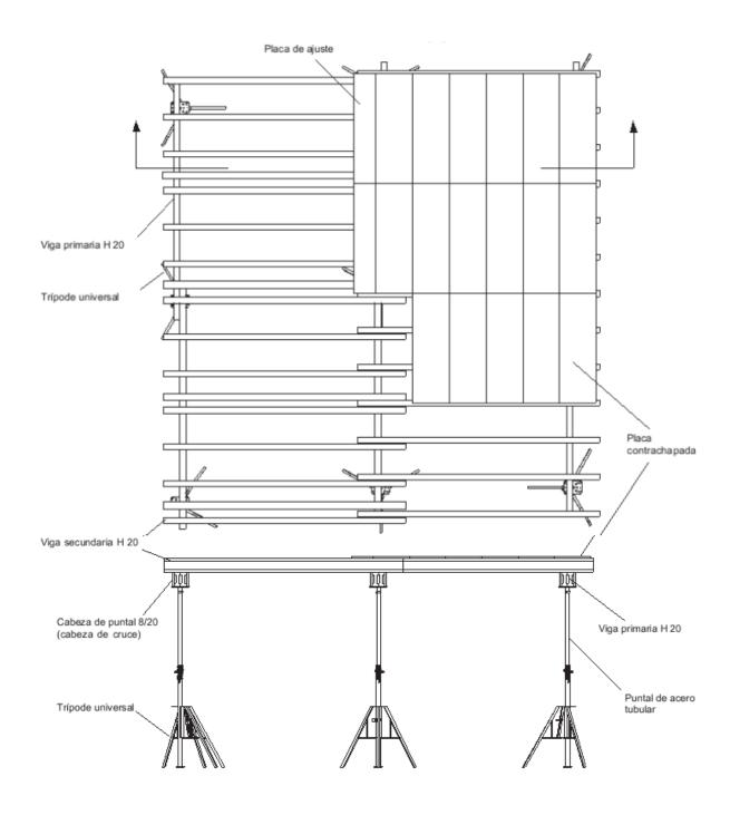
Metodología para desencofrado utilizando cabezas de puntal
