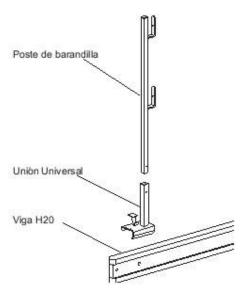
La figura muestra un rebalse de losas que conjuntamente sirve como dispositivo de protección frente a caídas. El poste de unión universal puede ser insertado en dos posiciones.
